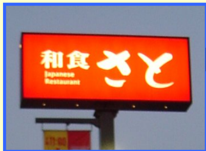
従来店看板照明 蛍光灯内照式 約1400W
